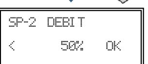
Appuyez sur ou pour modifier manuellement le paramètre. Cette valeur correspond au % sur la pression de consigne lorsque le ventilateur est en position nuit. Pour ce faire, vous pouvez connecter une horloge ou un interrupteur sans puissance dans l'entrée
