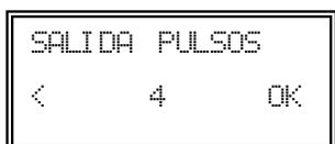
Pulsar o para modificar manualmente el parámetro que permite visualizar la velocidad del motor mediante la salida J8 (TACOM). **Se aconseja no modificar.**
